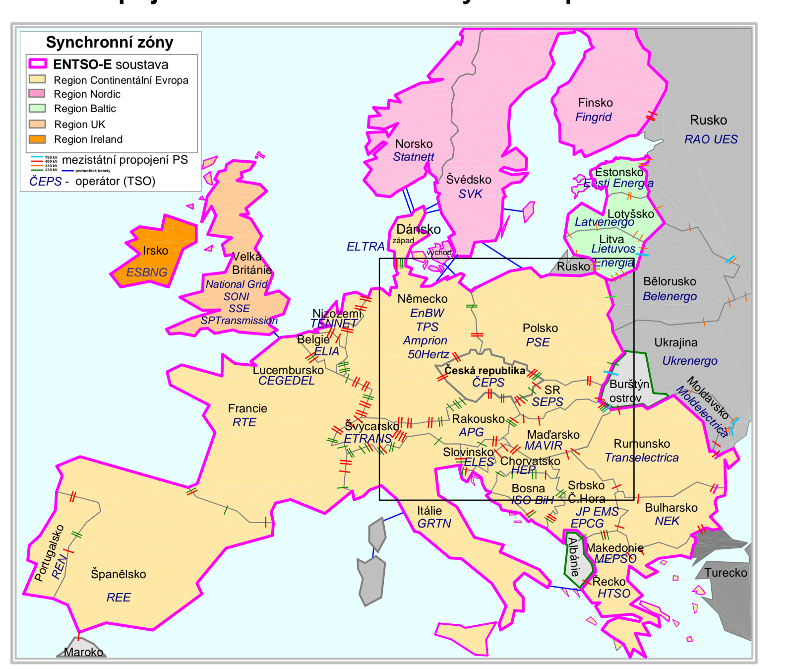
Propojené elektrizační soustavy v Evropě - 2010
